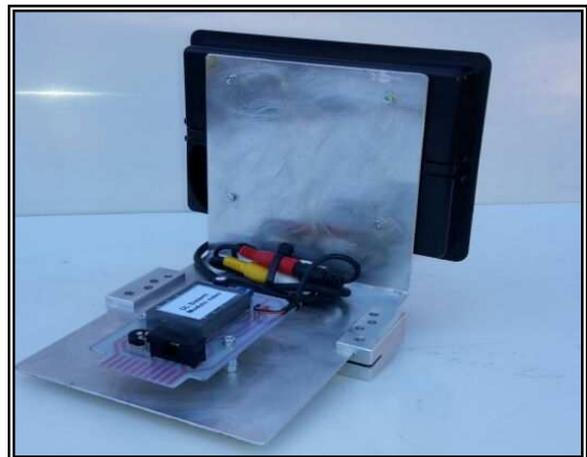
Il fissaggio del monitor è molto semplice. Come si può osservare dalle immagini, il monitor è fissato al carter della monta pettini tramite due ganci ( Immagine di sinistra ) che ne rendono regolabile la centratura e la profondità.
