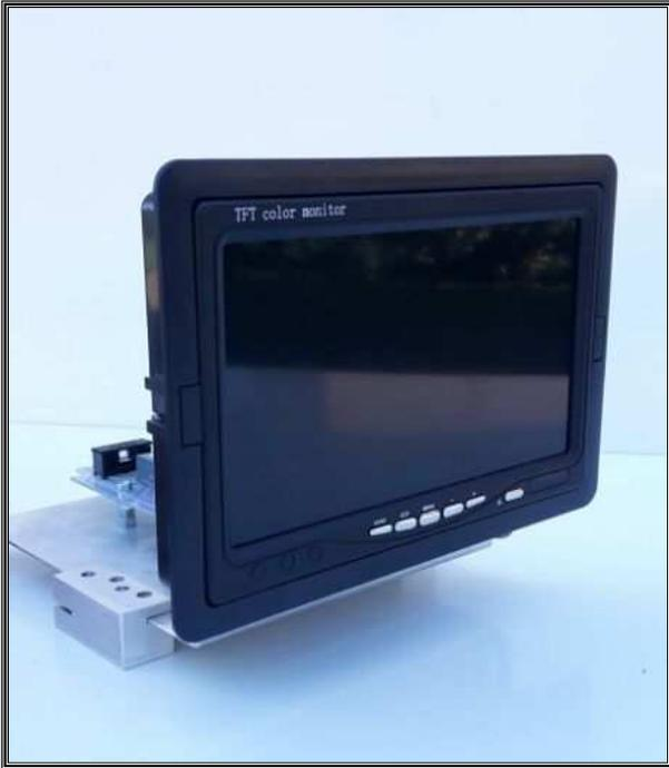
Questo prodotto è stato realizzato da **DI LUPO SISTEMI** nel 2015, ha la funzione di sostituire i monitor su macchine monta pettini PROTTI ormai obsoleti; difficili da trovare o riparare.
