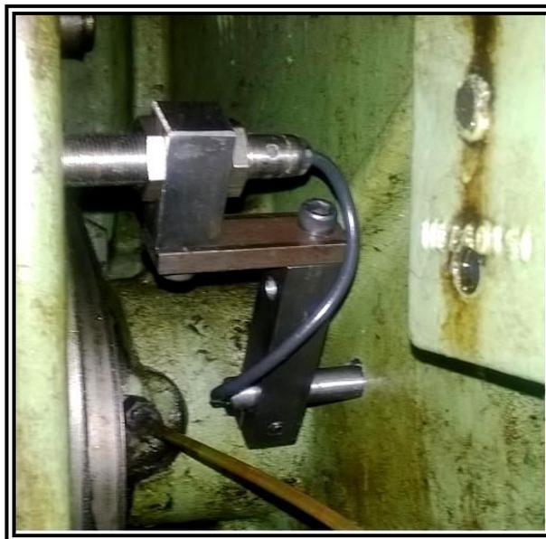
Fig.12.D (Montaggio sensore di Rest)
