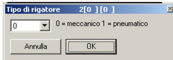
Qui possiamo scegliere il tipo di controllo del cambio colore, meccanico o pneumatico. Il programma gestisce automaticamente i rispettivi comandi secondo la necessità.
