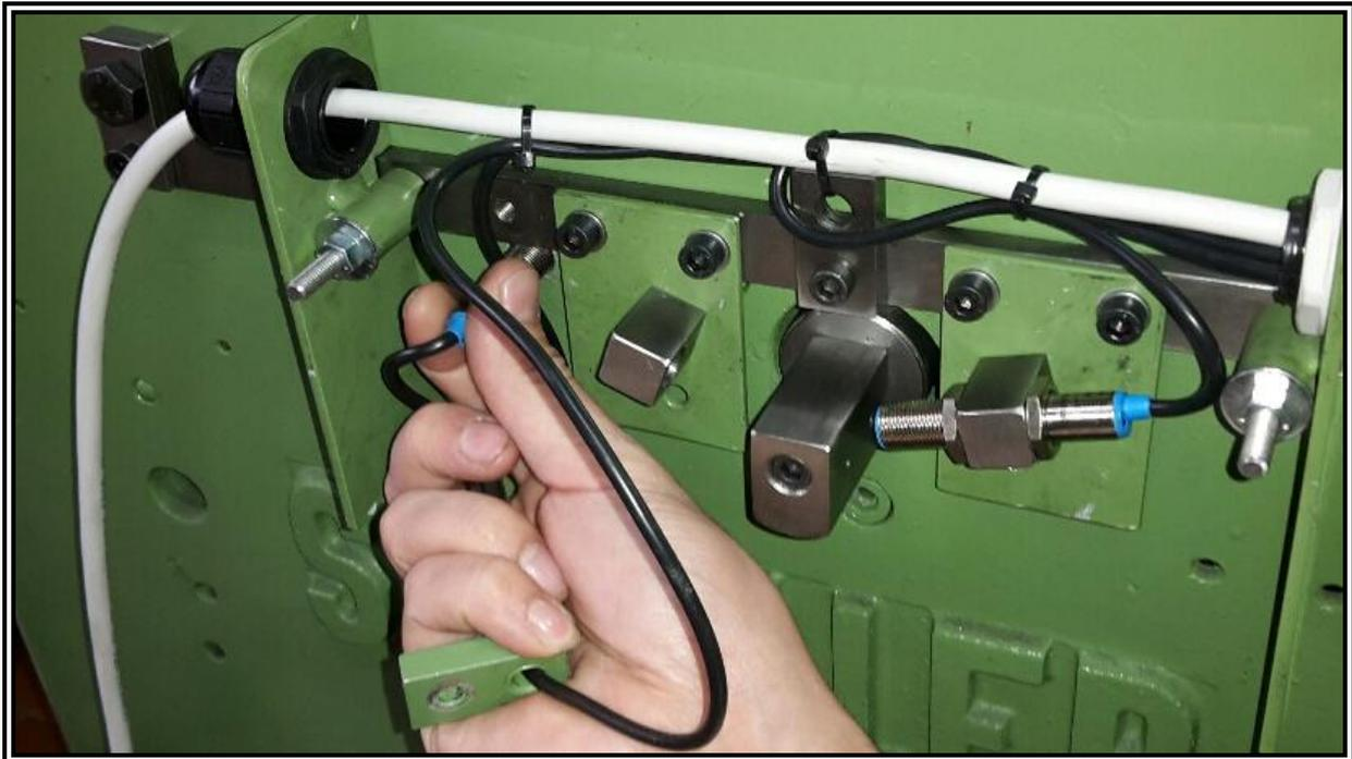
Fig.12.C (Fare passare il sensore all'interno del foro)
