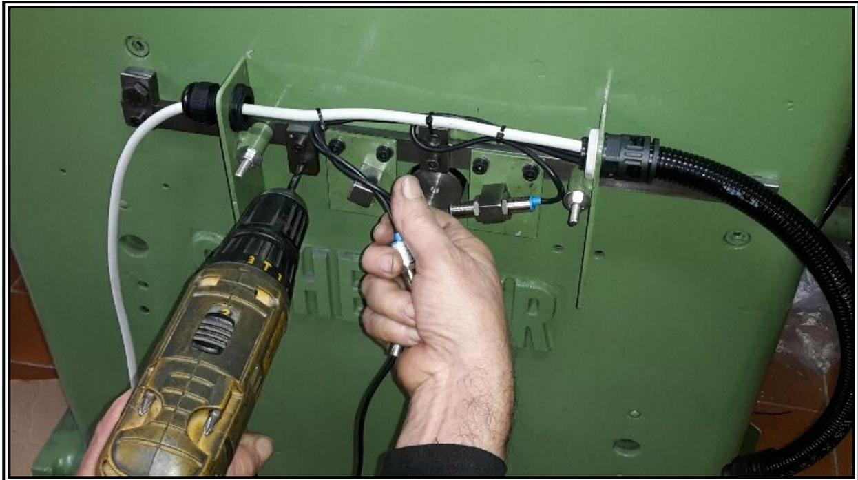
Fig.11.A (Utilizzare il calibro a corredo eseguire un primo foro)
